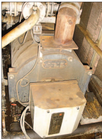
Die Vorwärm- und Warmhalteanlage einer Baureihe 294 5 . Sie ist prinzipiell nichts anderes als ein Heizkessel der bei manchem auch im Keller steht.
